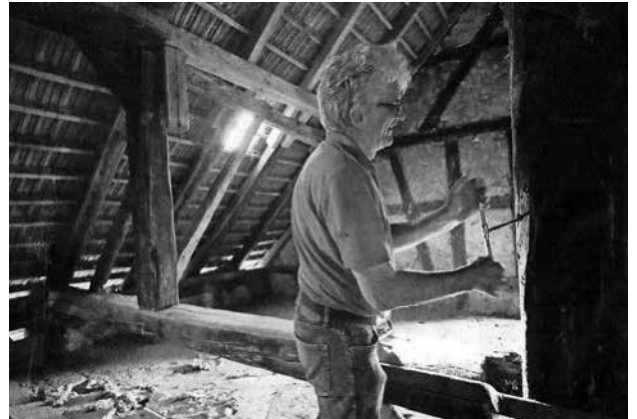
Mit einem Handbohrer entnimmt Jean-Pierre Hurni (Laboratoire Romand de Dendrochronologie) einen Holzkern, an dem sich anhand der Jahresringe das Alter des Baumes ablesen lässt. (Foto: Balz Murer)
